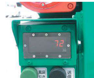
収集したごみの量を計測するスケールパッカー
