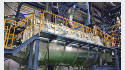
クッカー(廃棄物投入後、約4時間でバイオマス燃料に加工)
